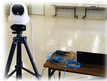
サーモグラフィー
