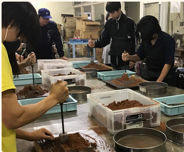
さまざまな工具を使って砂型を作ります
