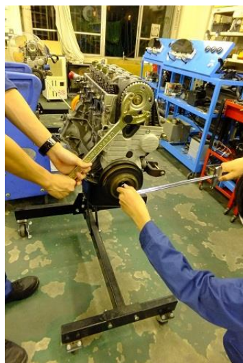
2 学年自動車実習(自動車用四気筒エンジンの分解組立)
