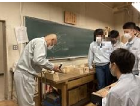
「のみ」の使い方も、棟梁の実演を見て、少しずつ削ります。最後の組み合わせる調整にも使います。
