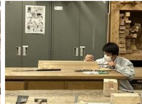
「のみ」の使い方も、棟梁の実演を見て、少しずつ削ります。最後の組み合わせる調整にも使います。
