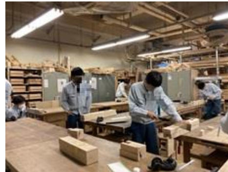
「のみ」の使い方も、棟梁の実演を見て、少しずつ削ります。最後の組み合わせる調整にも使います。
