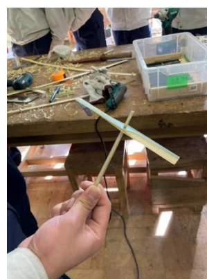
竹を植木はさみで割って、厚さを少し薄くして、表面に取り付けていきました。
