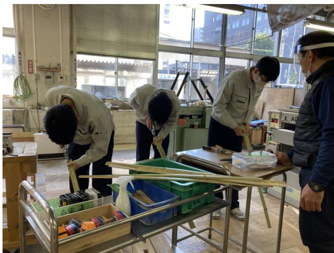
竹を植木はさみで割って、厚さを少し薄くして、表面に取り付けていきました。
