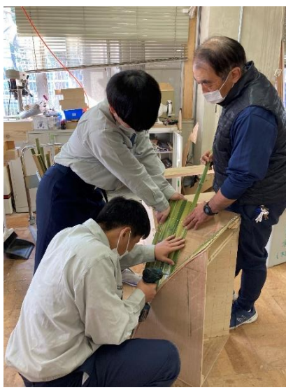
竹を植木はさみで割って、厚さを少し薄くして、表面に取り付けていきました。
