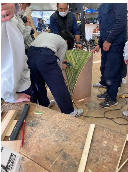
竹を植木はさみで割って、厚さを少し薄くして、表面に取り付けていきました。
