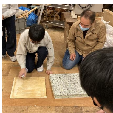
↑初めて見る椅子の座面の中 ←↑硬さの違うウレタンフォームを組み合わせる座面をつくっていきます。先生の丁寧な手元に注目です。表面に布をかけると、椅子らしくなります。
