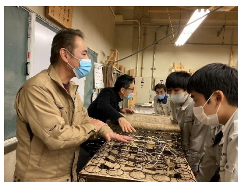
↑初めて見る椅子の座面の中 ←↑硬さの違うウレタンフォームを組み合わせる座面をつくっていきます。先生の丁寧な手元に注目です。表面に布をかけると、椅子らしくなります。
