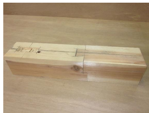
↑腰掛けあり継ぎ組み合わせ後
