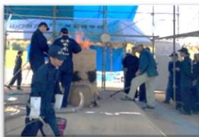
山口県立宇部工業高等学校による「たたら製鉄」復元操業。作業は一昼夜に及び、機械を使わず、人力での製鉄を行う。
