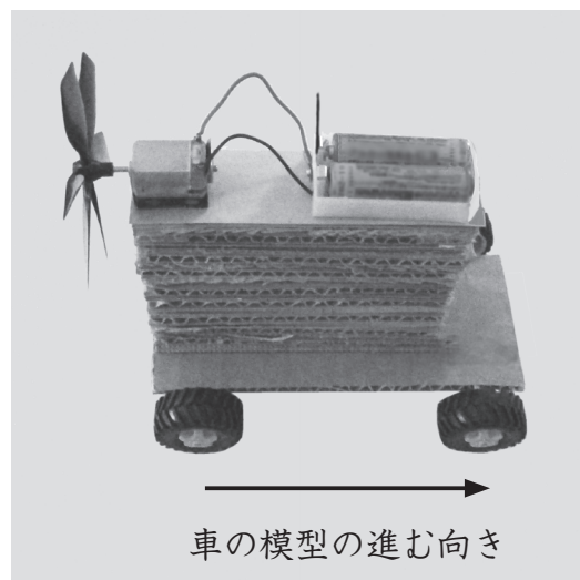
図1 風を起こして走る車の模型
