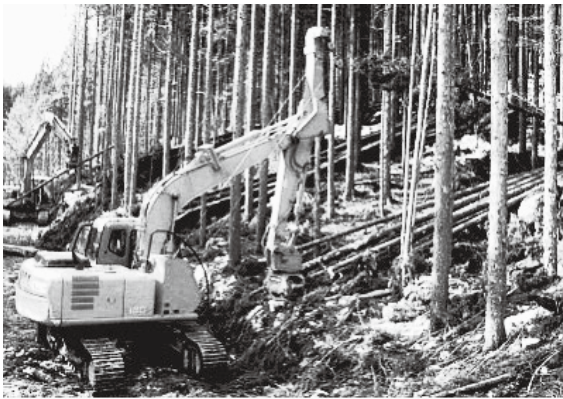
高性能の林業機械を使った間ばつの様子
