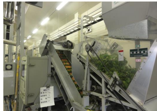
製茶工場内の設備: 写真は生葉流量計
