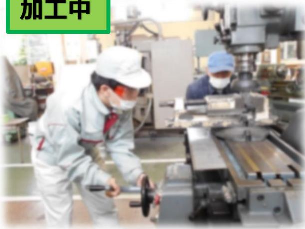
フェイスミル (金属を削る刃物)
