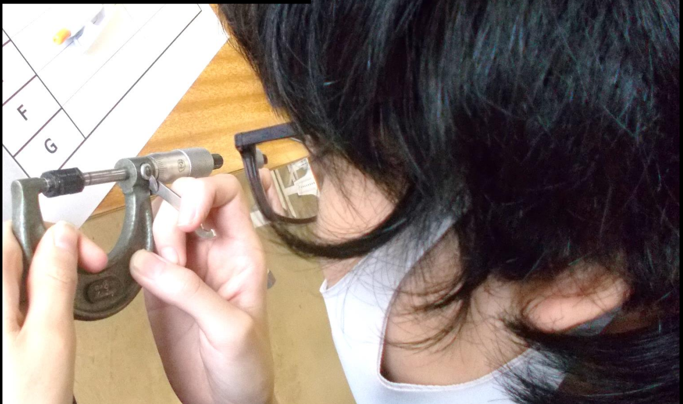
【技能検定 機械検査 3 級】 0 点合わせの調節を行っています。
