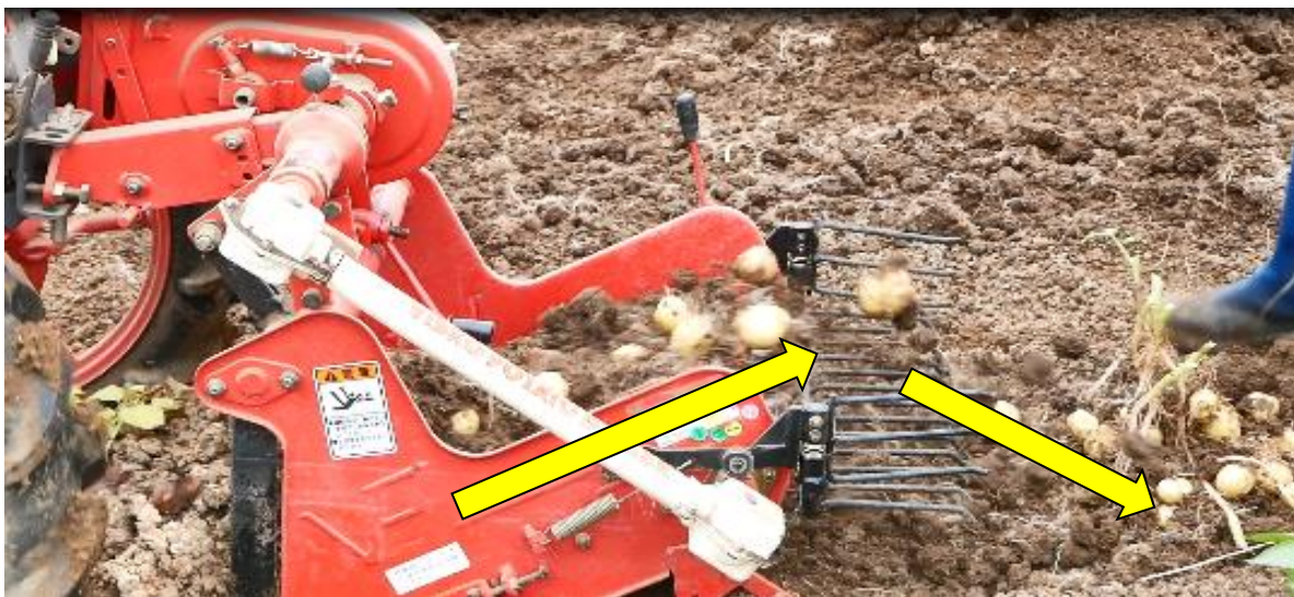
⑤掘り上げたジャガイモが、コンベアで足元に流れてきます。
