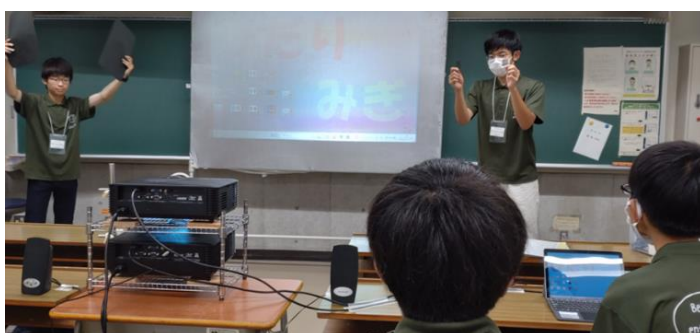
写真6 投影用のプロジェクタ 右眼用と左眼用の2台を用いる。立体感を出すためには、厳密な調整が必要となる。
