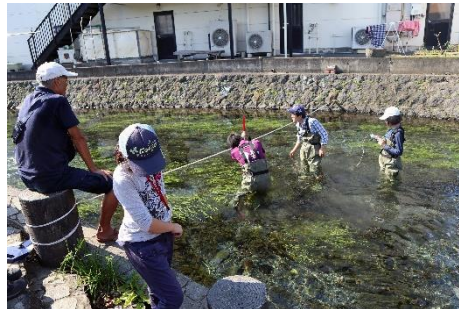
プライス流速計で平均水深の流速を測定
