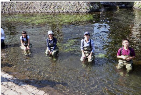
1mごとに水深を測定して川の断面積を求める
