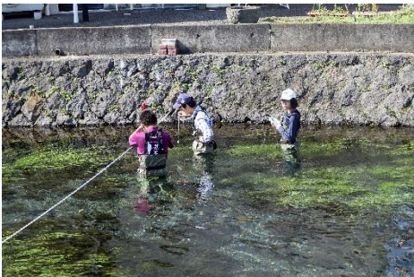
1mごとに水深を測定して川の断面積を求める
