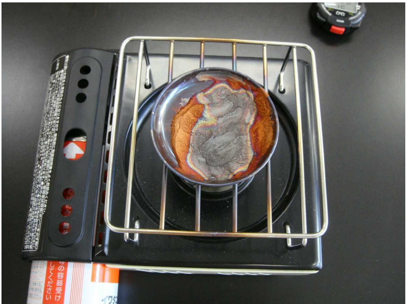
図 1 3 銅の酸化の実験装置
