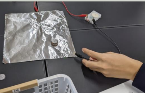
2種類の金属と食塩水から電池を作る
