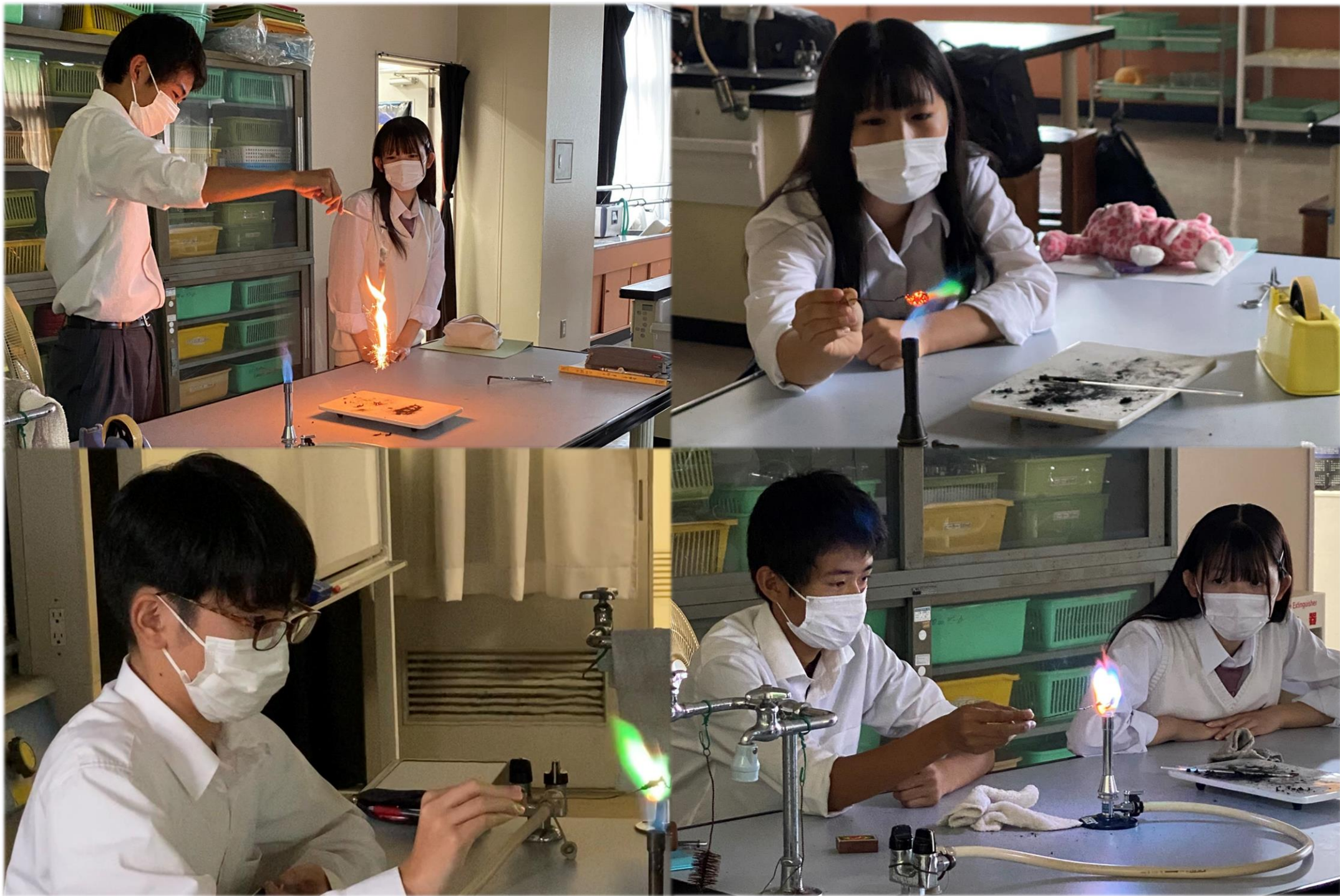
物質の種類と形状によって、燃焼の仕方が異なることを確認しました。左上が鉄粉の燃焼、それ以外が銅線を用いたバイルシュタイン反応（銅と塩素の反応）の様子です。
